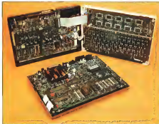
Funzionamento delle due macchine aperte. In alto a sinistra il computer completo, in basso a sinistra il computer senza schermo (collegato con microprocessore e display driver) e la tastiera.
